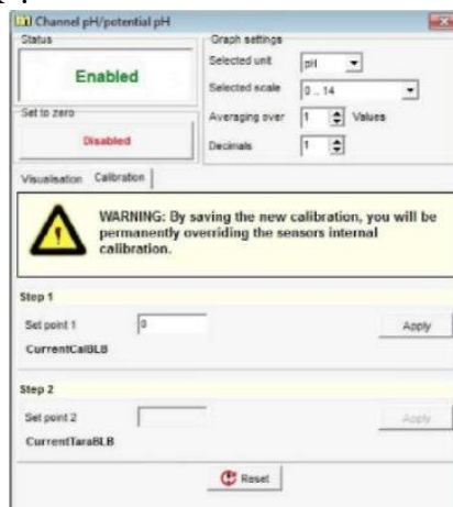
Рисунок 2. Настройки режима калибровки сенсорного датчика
