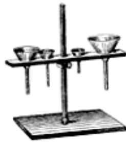
Химические воронки и их крепление
